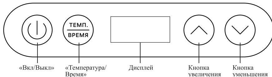
На панели управления расположены дисплей, кнопка «Вкл/Выкл» и кнопки настройки времени и температуры. Все кнопки сенсорные.
